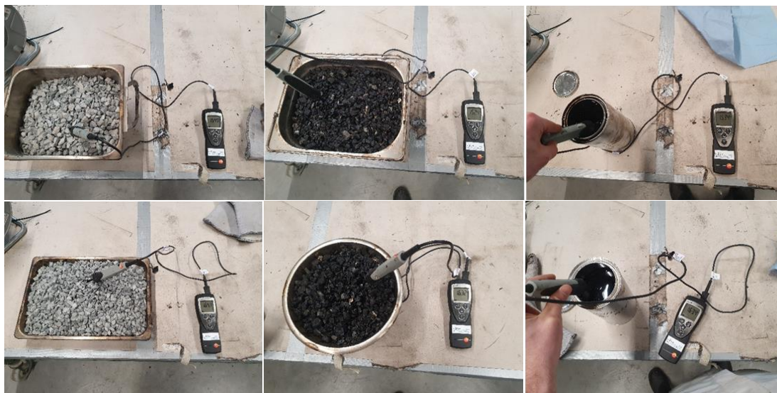
Figuur 2.4: Tempratuurcontrole voor het mengen. Gewenste opwarmtemperatuur 153 \pm 5 \text{ }^\circ\text{C} (boven) en 163 \pm 5 \text{ }^\circ\text{C} (beneden).
