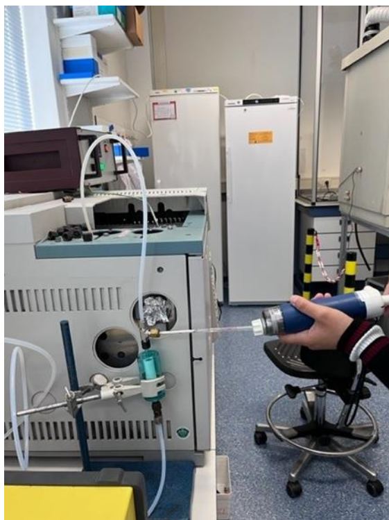
Figuur 2.6: Bemonstering van lucht op een Tenax™ buis middels een handluchtpomp.
